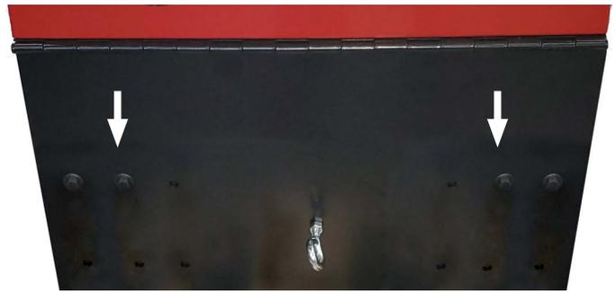
6. Haga coincidir los orificios de la parte posterior o de las bridas de las cunas para carros con un juego de orificios del CartManager Ultra. Se puede utilizar un juego de orificios diferente para cada lado, no es necesario que ambos sean iguales.
